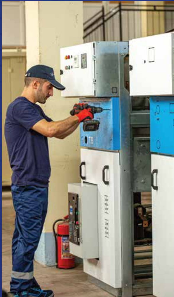
İstehsalat prosesində 6/10 kV-luq yuvaların hazırlanması
