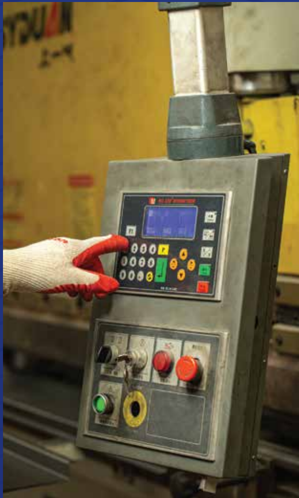
Əymə dəzgahında parametrlərin saxlanması
