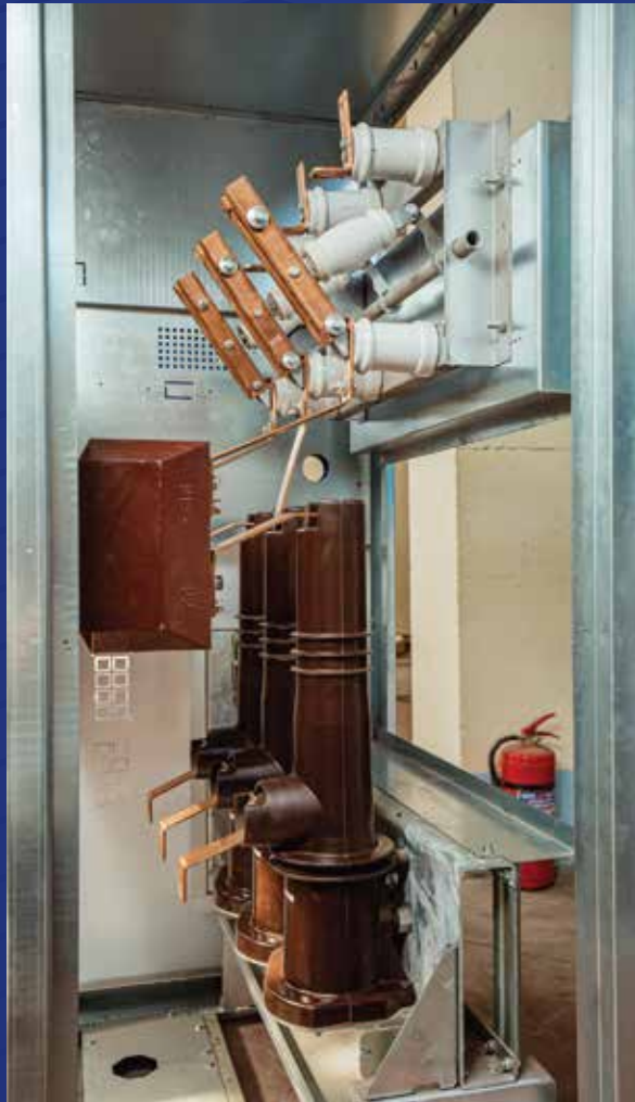
İstehsalat prosesində 6/10 kV-luq yuvaların hazırlanması
