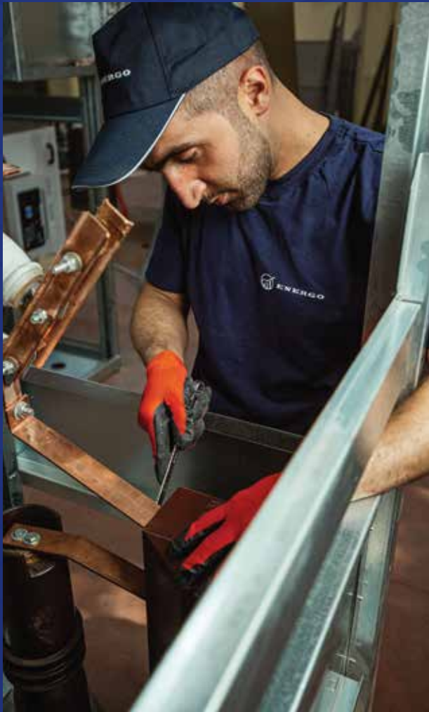
İstehsalat prosesində 6/10 kV-luq yuvaların hazırlanması
