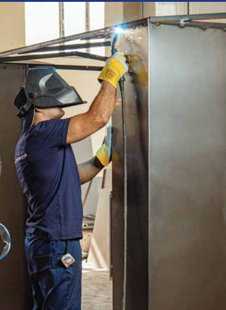
Komplekt transformator m nt q s nin hazırlanması, qaynaq işləri
