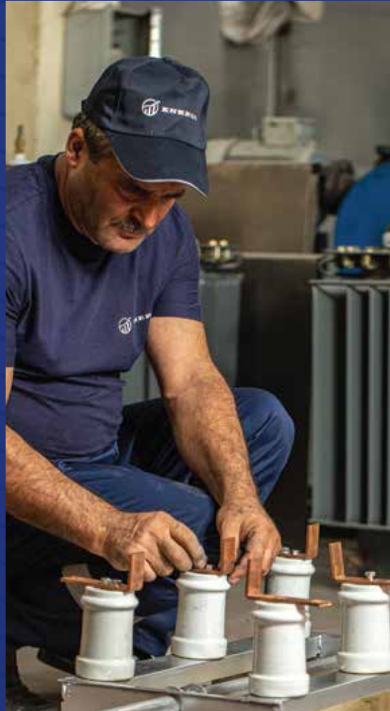
6/10 – kV-luq ayrıcıların hazırlanması
