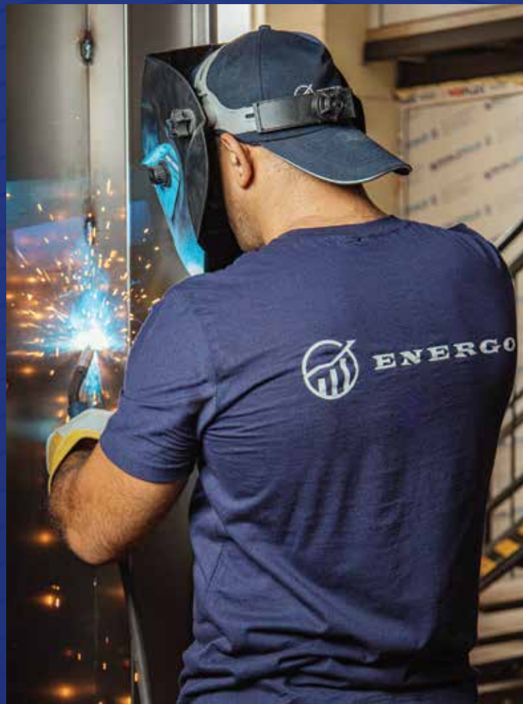
Komplekt transformator m nt q s nin hazırlanması, qaynaq işləri
